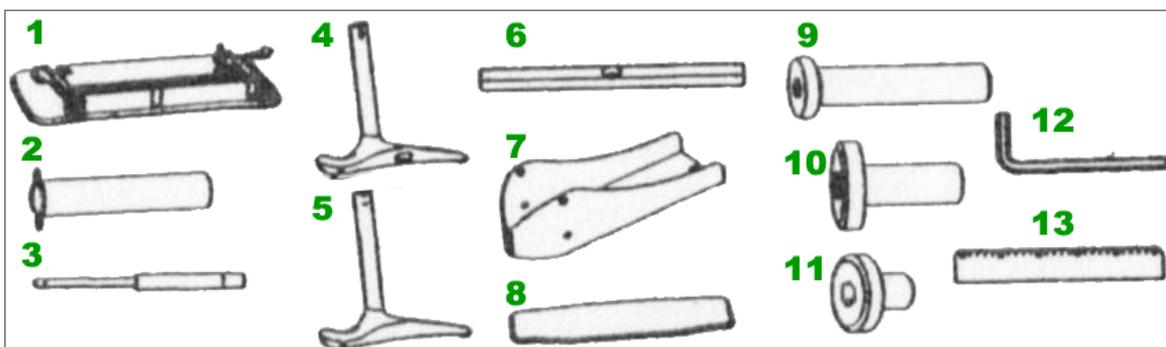
1 – основная панель столешницы; 2 – внешняя трубка газлифта; 3 – газлифт;
